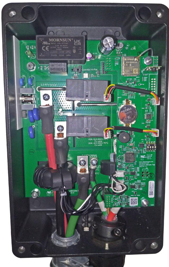
4. Faites passer les fils d'entrée (L1, L2, G) par le conduit dans le chargeur.
