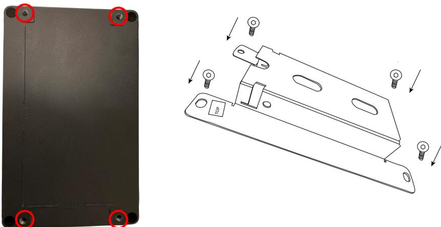
3. Fixez la partie arrière du support de montage au mur ou à une autre structure appropriée à l'aide des vis Robertson.
