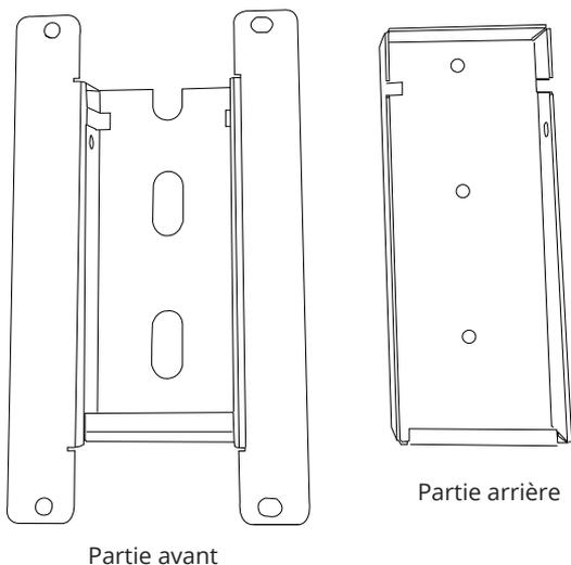
2. Fixez la partie avant du support de montage à l'arrière de la borne de recharge à l'aide des vis à tête creuse. Assurez-vous que le haut du support de montage est aligné avec le haut de la borne de recharge.
