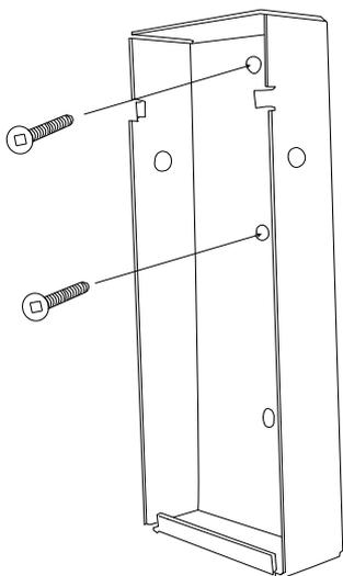
La partie arrière du support de montage comporte 3 trous pour permettre la fixation sur diverses surfaces. Utilisez les deux trous supérieurs pour fixer le support de montage à un montant mural.
